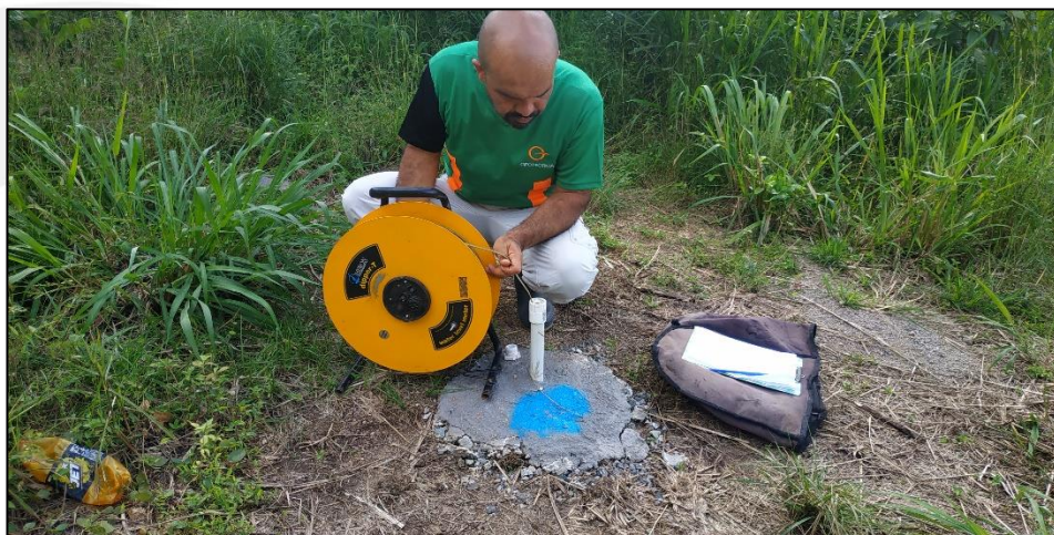
Fotografía N° 25. Piezómetro 1, dentro del deslizamiento El Picadero. Fuente: Propia.
