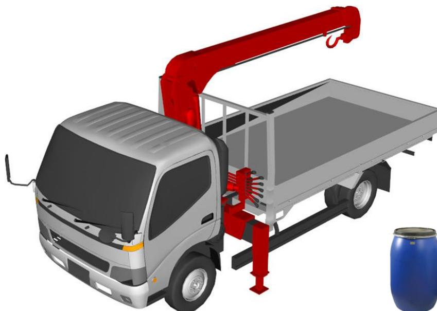
**Fig.5. Ejemplo de camión de carga liviana con grúa hidráulica para el levantamiento de estañones plásticos con residuos orgánicos hogareños y zacates de jardín.**
