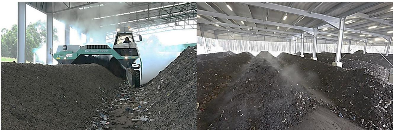
**Fig.7. Proceso de compostaje bajo techo o galera. Trabaja en menores áreas sin embargo lo puede hacer durante todo el año sin importar la condición climática del sitio.**
