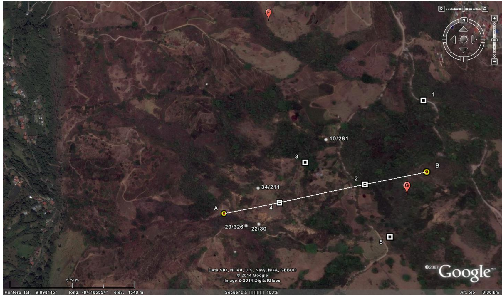
FIGURA 10. SITIO DEL DESLIZAMIENTO DE TAPEZCO, CON PERFIL GEOLÓGICO A-B DE LA FIGURA 11, Y PERFORACIONES 1 A 5 A PARTIR DE MOLINA (1990)
