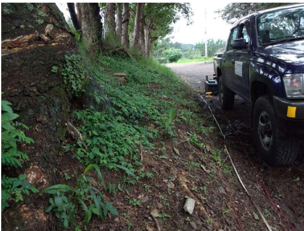
Fotografía N°23: Aplicación del SEV 2 sobre camino aguas arriba del brote.
