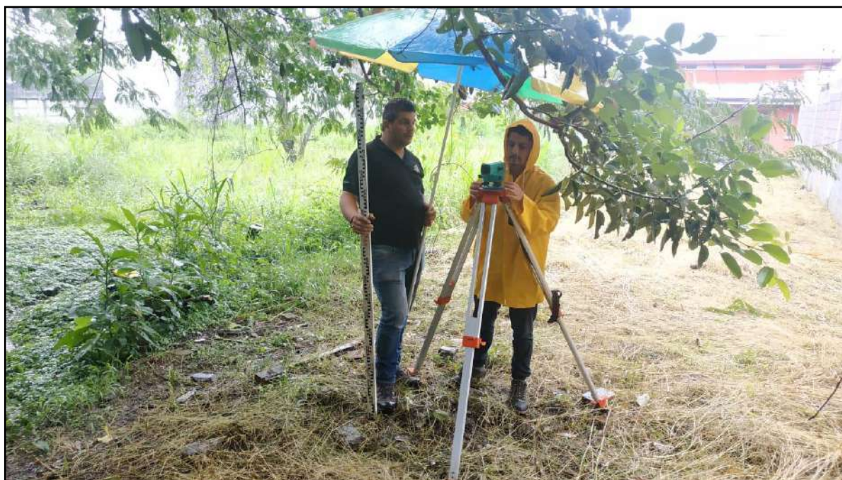
Fotografía N°15. Levantamiento topográfico del sector E-1 de la quebrada Pilas. Coordenadas: 479038E / 1101812N proyección CRTM-05.
