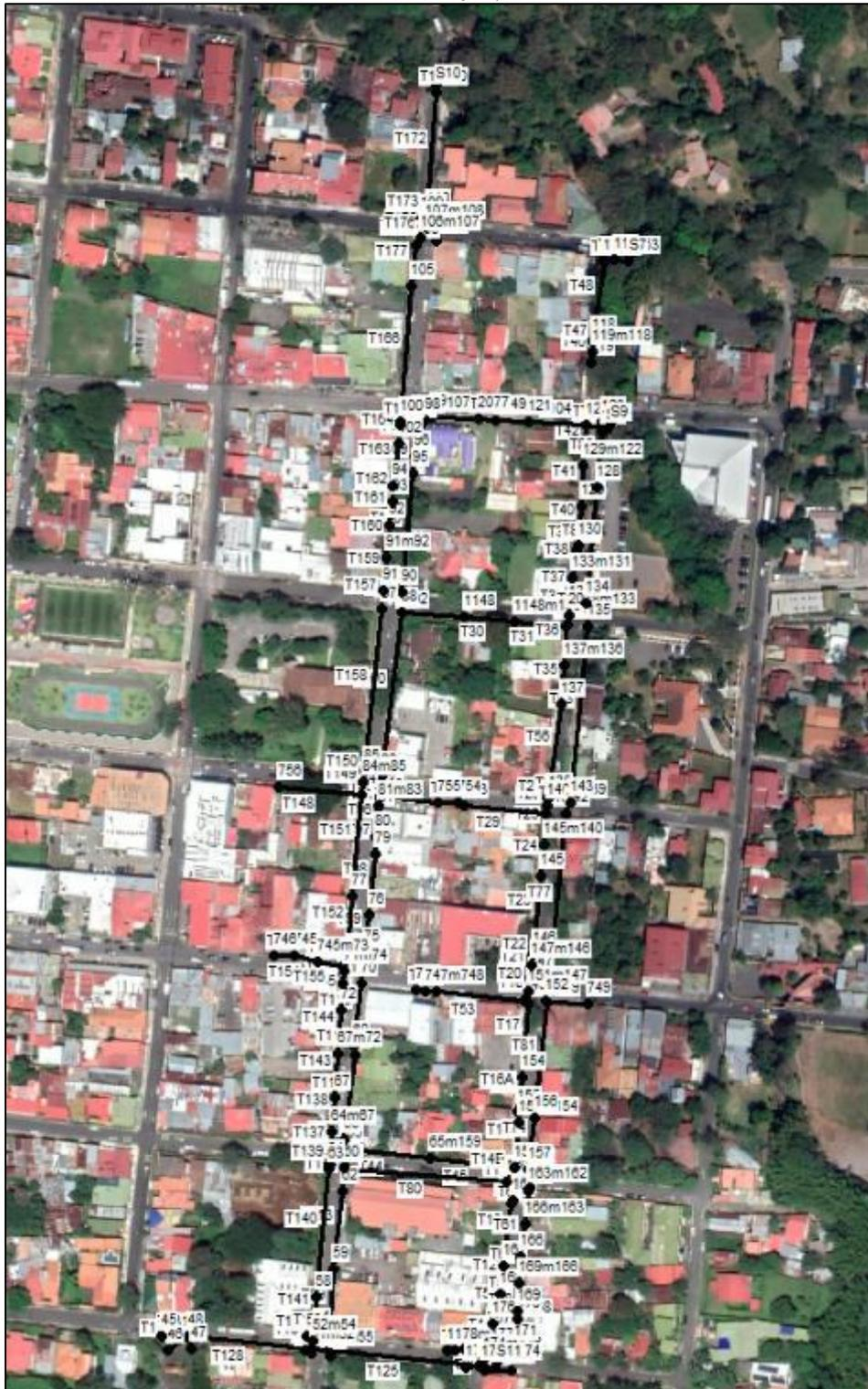
Figura 4.5. Esquema utilizado para el análisis del sistema pluvial existente, Conjunto IV (sistemas 1, 2, 4, 10, 11, 12, 13, 14, 15 y 16)
