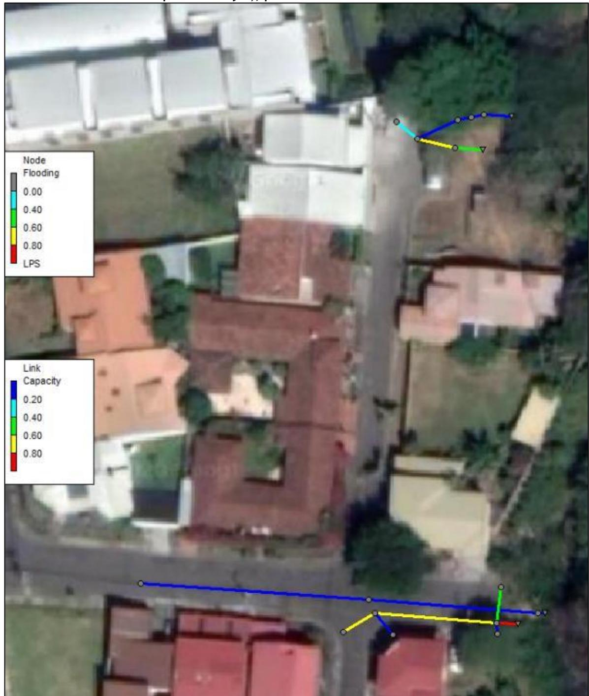
Figura 5.10. Resultados del modelo SWMM para la propuesta de mejoras del Conjunto I (sistemas pluviales 3 y 4), perfil de niveles para período de retorno 25 años
