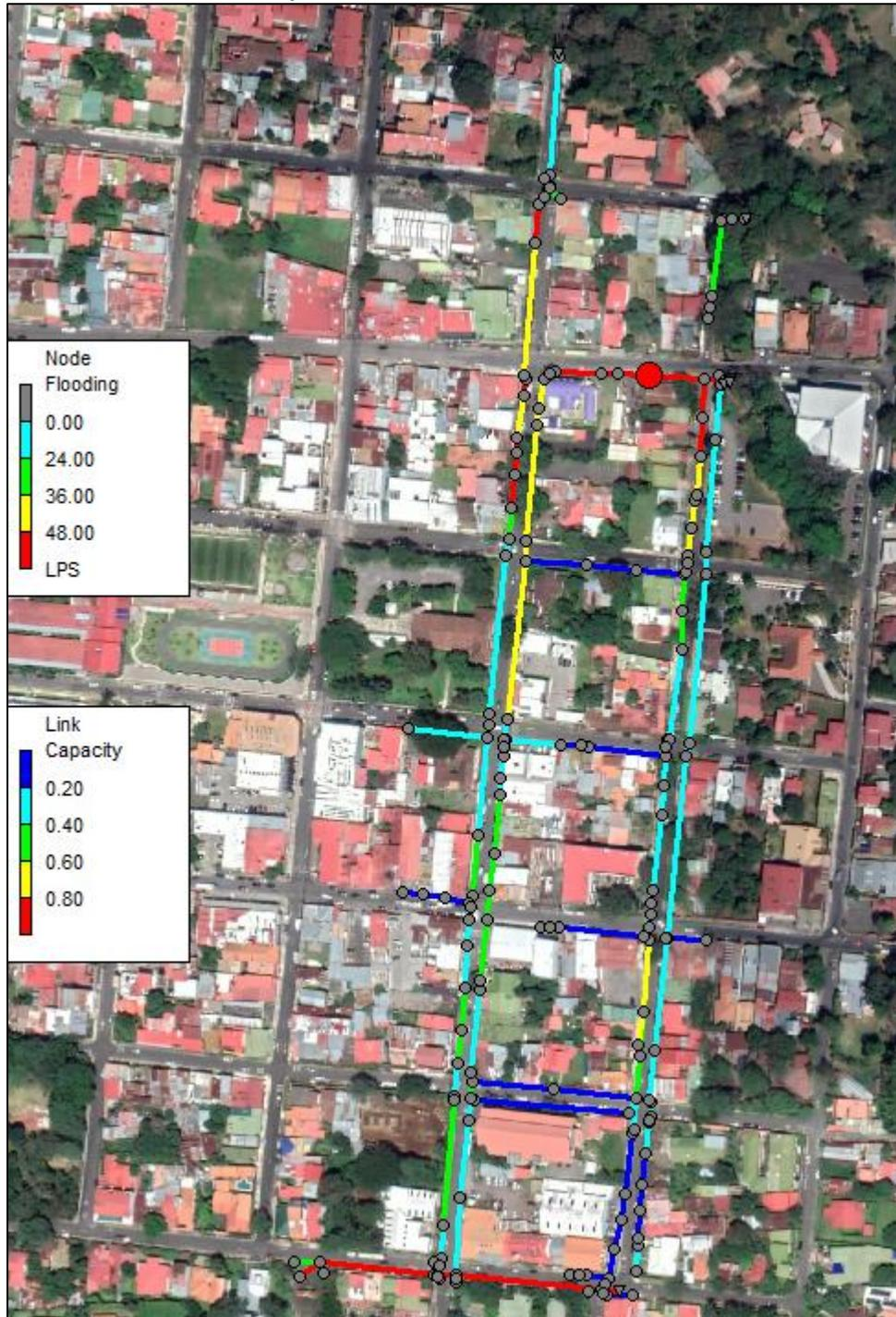
Figura 4.14. Resultados del modelo SWMM para el Conjunto II (sistemas pluviales 5, 6, 7, 8 y 9), período de retorno de 5 años
