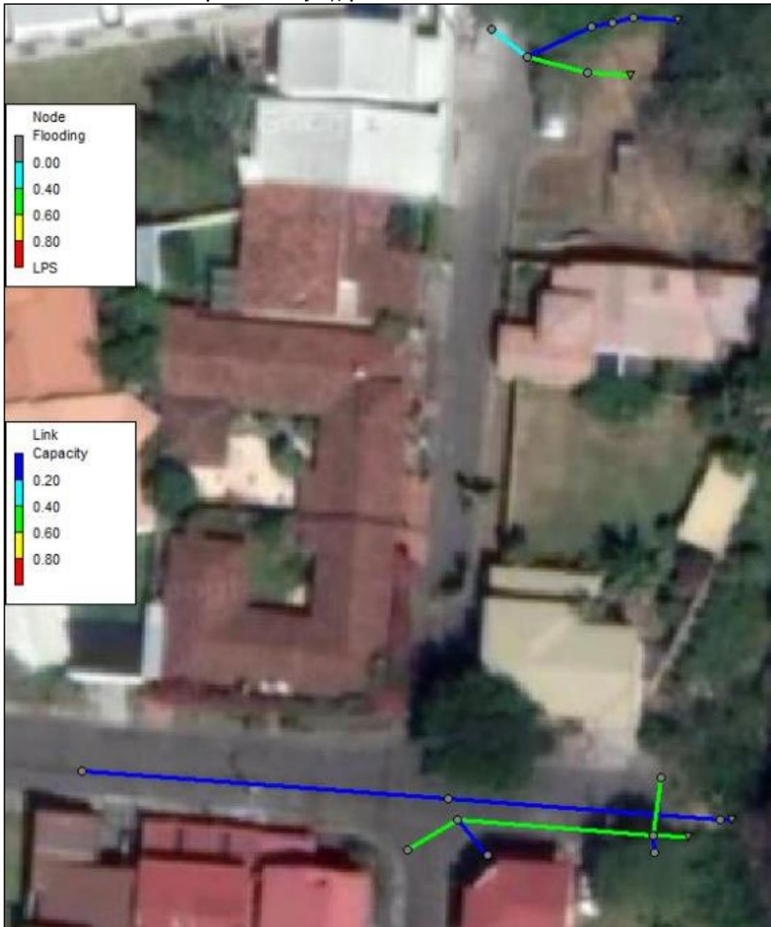
Figura 5.7. Resultados del modelo SWMM para la propuesta de mejoras del Conjunto I (sistemas pluviales 3 y 4), período de retorno 5 años
