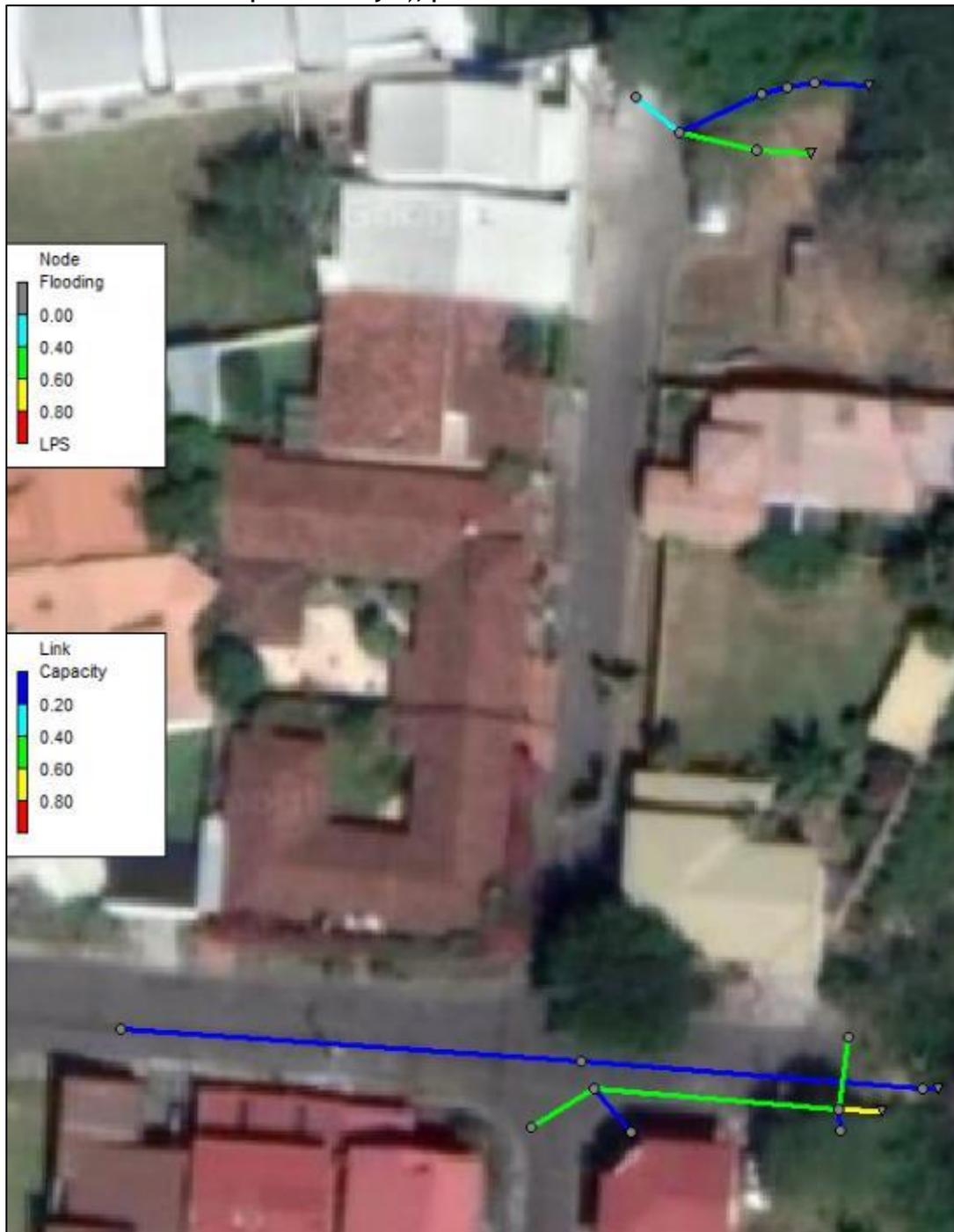
Figura 5.8. Resultados del modelo SWMM para la propuesta de mejoras del Conjunto I (sistemas pluviales 3 y 4), período de retorno 10 años
