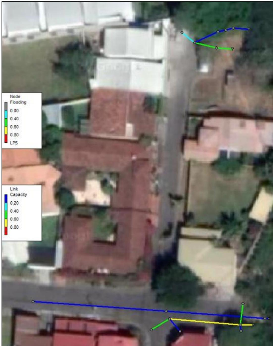
Figura 5.9. Resultados del modelo SWMM para la propuesta de mejoras del Conjunto I (sistemas pluviales 3 y 4), período de retorno 25 años
