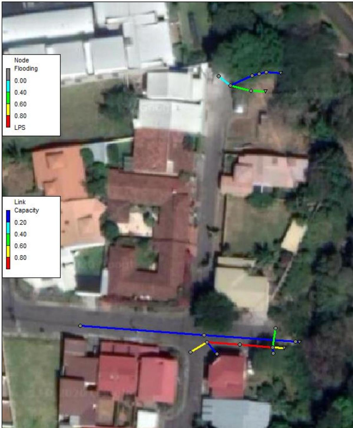
Figura 4.10. Resultados del modelo SWMM para el Conjunto I (sistemas pluviales 3 y 4), período de retorno de 25 años
