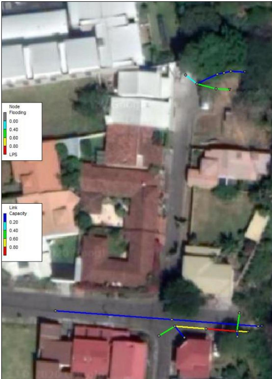
Figura 4.8. Resultados del modelo SWMM para el Conjunto I (sistemas pluviales 3 y 4), período de retorno de 5 años
