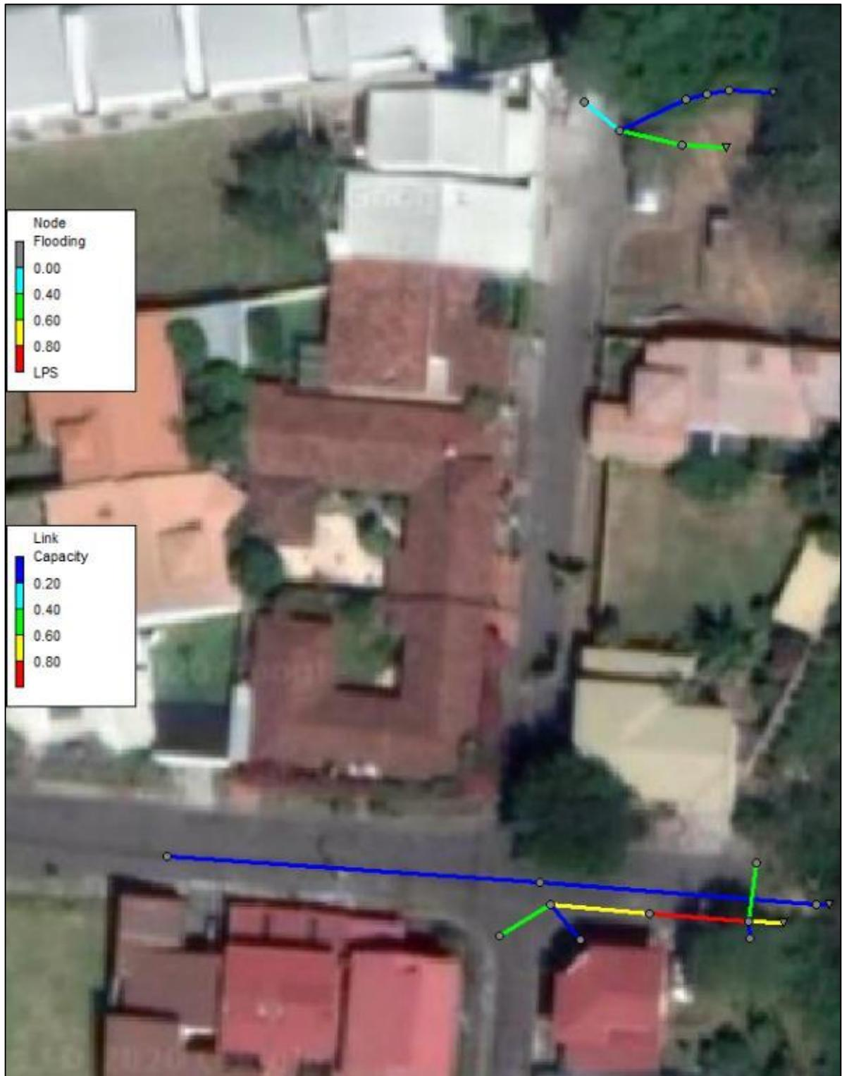
Figura 4.9. Resultados del modelo SWMM para el Conjunto I (sistemas pluviales 3 y 4), período de retorno de 10 años
