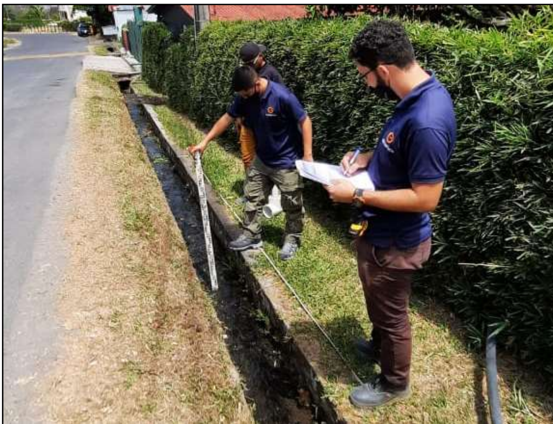
Fotografía N°2. Aforo 3, aplicado al canal que transporta el flujo de concesión hacia cultivos de cebolla el agua pluvial. Coordenadas: 479687E /1097275N proyección CRTM-05.
